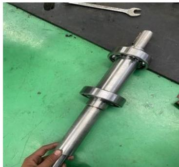
*Gambar 4 13 Pemasangan Bearing*
