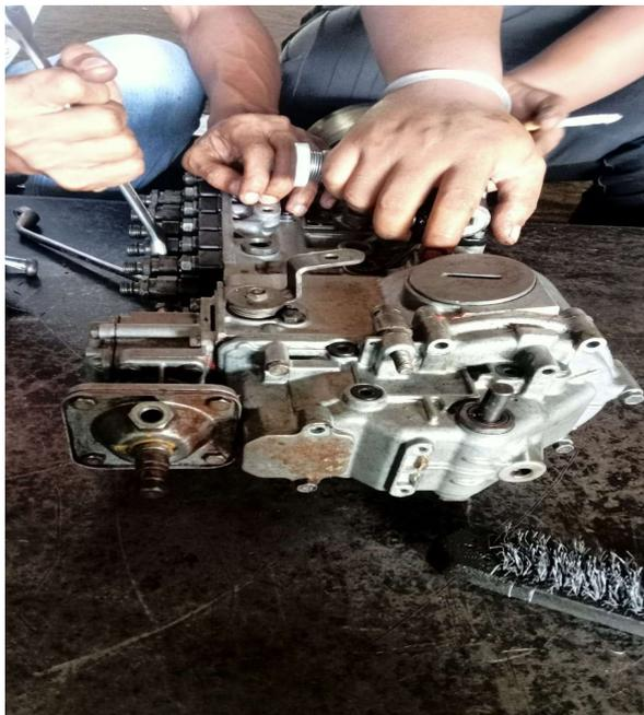
*Service* pomp solar pembersihan dan pengecekan pada setiap selang ke *nozle* mencegah terjadinya kebocoran.
