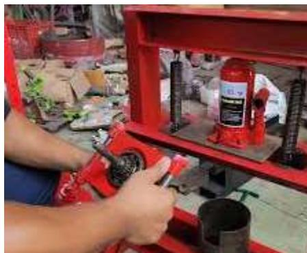
Gambar 4. 14 masangan *Silinder* Hidrolik
