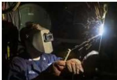
Gambar 4. 6 Las MIG (*Metal Inert Gas*)
