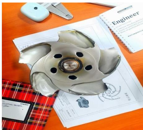
Gambar 4. 12 *Impler* pompa sentrifugal
