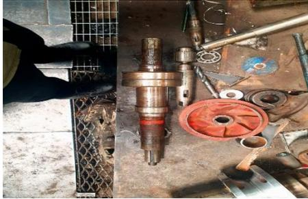
*Gambar 4. 20 Ilustrasi perbaikan shaft bengkok*
