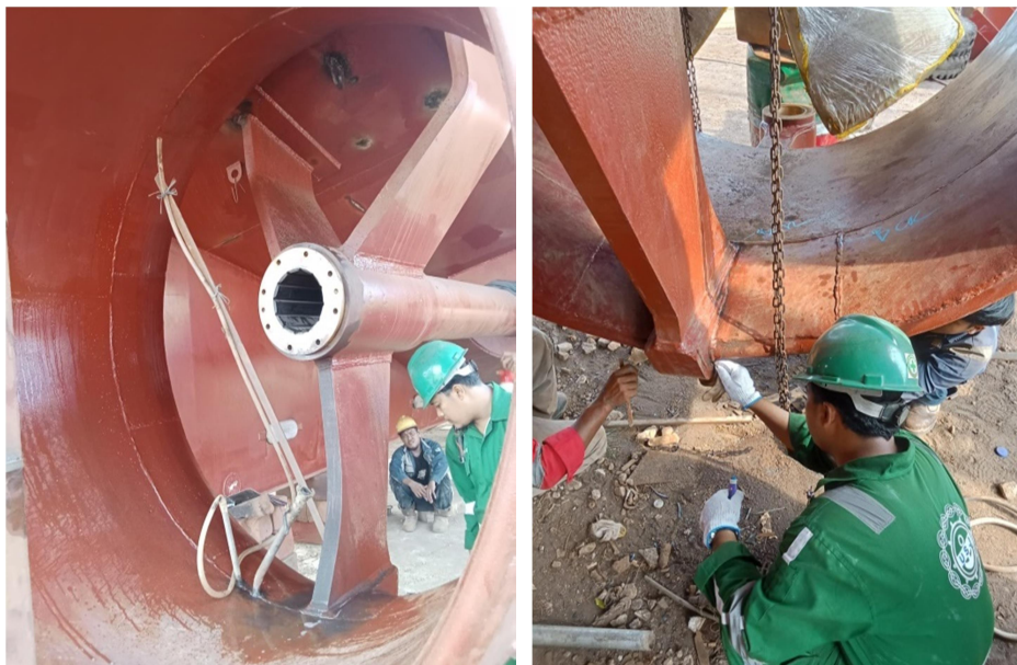
Gambar 2.27 Air Test Kort Nozzle
