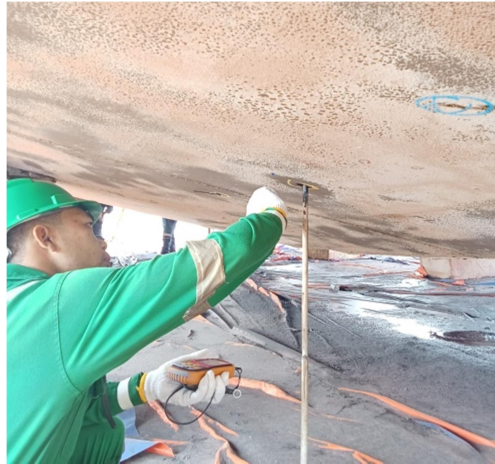
Gambar 2.24 UT Thickness bottom
