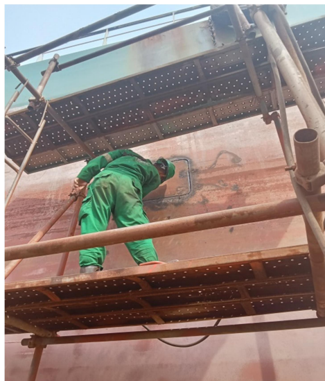
Gambar 2.81 Pengecekan insert plate
