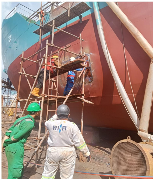
Gambar 2.89 UT Insert Plate
