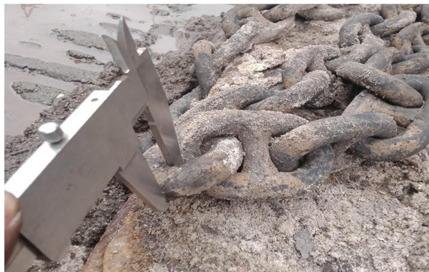
Gambar 3.2 pengukuran rantai bagian dalam (d)
