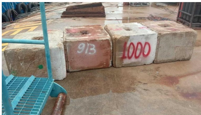
Gambar 3.3 Beban untuk Inclining Test
