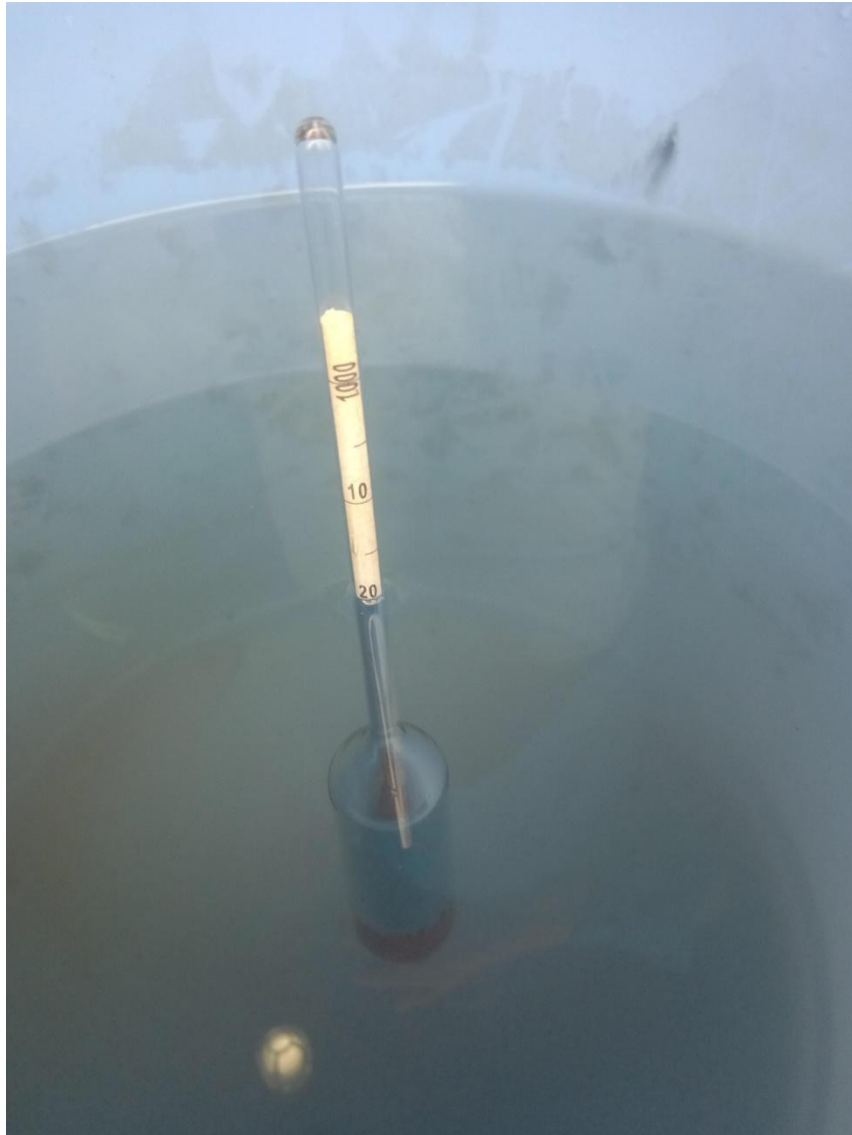
Gambar 2.29 Pengujian air menggunakan Densitometer
