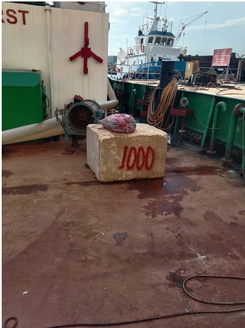
Gambar 2.27 Peletakan Pemberat ke atas kapal
