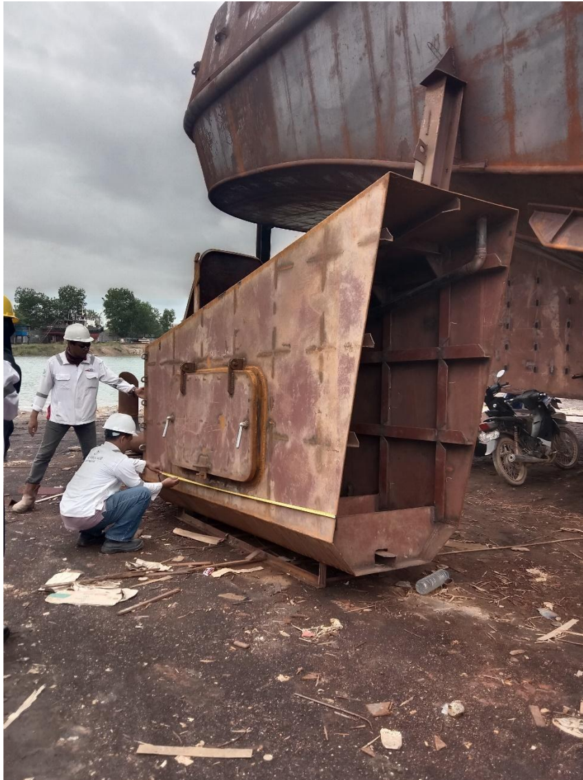
Gambar 2.64 Mengukur Funnel pada Kapal Tugboat 29 meter
