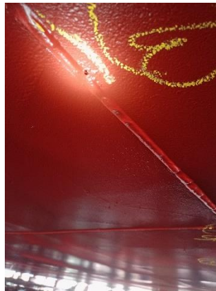
Gambar 2. 87 Porosity di bottom
