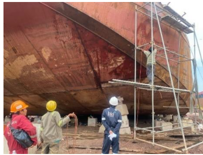
Gambar 2. 40 Mengecek Kebocoran saat External AirTest di Hull 19
