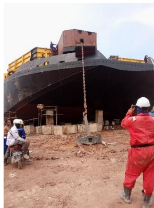
Gambar 2. 41 Fit up rantai jangkar ke mesin Windlass
