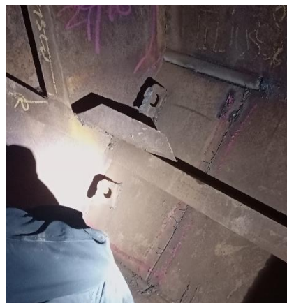
Gambar 2. 69 Miss Weld pada chine
