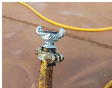
Gambar 3. 13 Pemasangan Chicago coupling di selang angin
