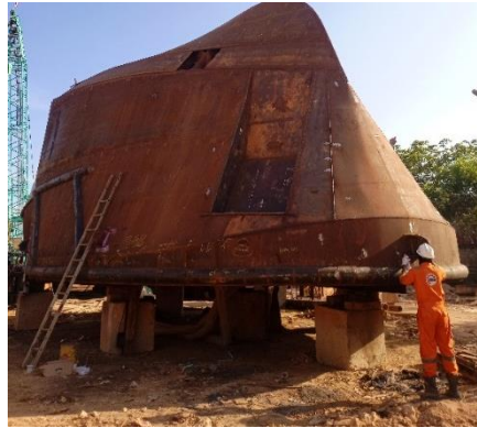
Gambar 2. 2 Liquid Penetrant test pada kupingan head hull 065
