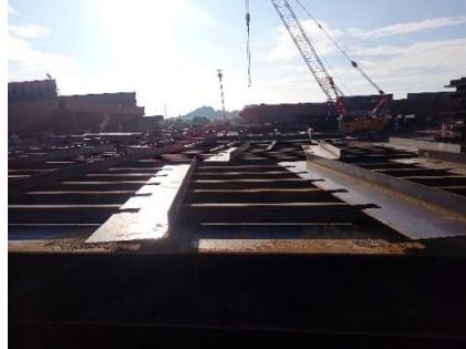
Gambar 2. 28 Scantling pada panel Bottom
