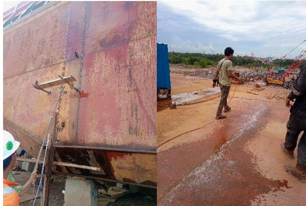
Gambar 3. 24 Proses penyemprotan air sabun air sabun di side sheel dan main deck
