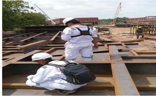
Gambar 2.32 Visual Test Bottom P,CP,S dan CS Makassar Bay 2336
