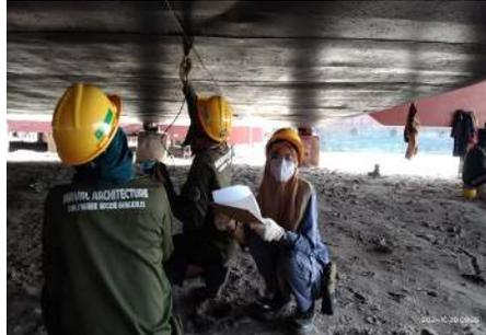
Gambar 2.82 Ultrasonic test pada bottom bagian Tongkang KHB 2511
