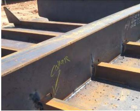
Gambar 2.32 visual test cp dan c tongkang h 180
