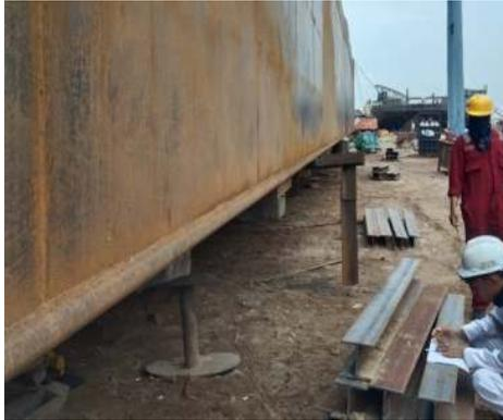
Gambar 2.30 Pembuatan Seam Joint Tongkang
