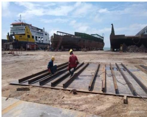
Gambar 3.5.6. Fit up panel bottom tongkang
