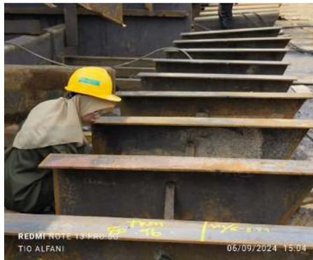
Gambar 2.43 Visual test tongkang h 181 bagian transom
