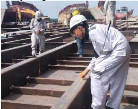
Gambar 2.34 Visual test tongkang di Jetty 3 bagian bottom
