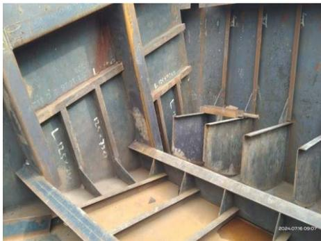
Gambar 2.5 Visual Test pada buritan kapal tongkang.
