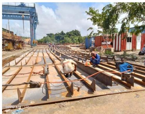
Gambar 3.5.10. Welding bottom tongkang
