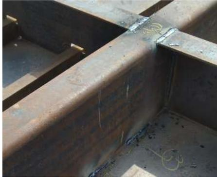
Gambar 2.42 Visual test tongkang h 181 bagian side Shell
