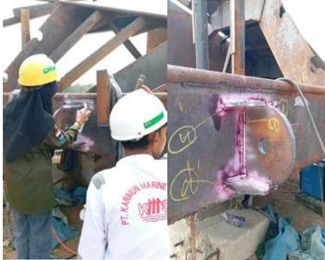
Gambar 2.12 Penetrant Test kupingan Tongkang 176
