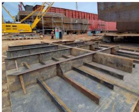
Gambar 2.45 Visual test tongkang bagian side Shell
