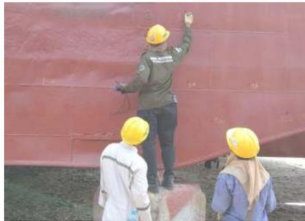
Gambar 2.80 Ultrasonic test bottom dan side shell
