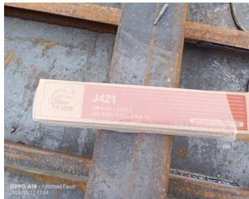
Gambar 3.5.8. Jenis electroda yang digunakan
