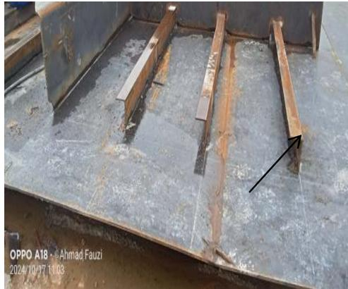
Gambar 3.2.3. Angle bar pada Plat bottom tongkang
