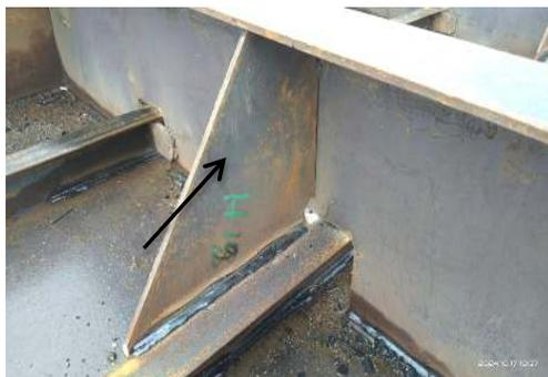
Gambar 3.2.9. Bracket pada panel bottom tongkang
