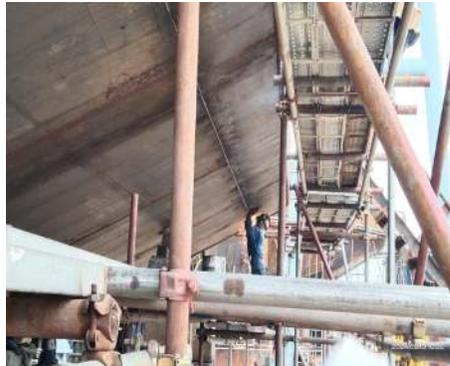
Gambar 2.44 Proses googing pada tongkang
