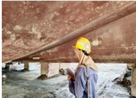
Gambar 2.73 UT Kapal KMP. Bahtera Nusantara bagian Bottom dan Side Shell
