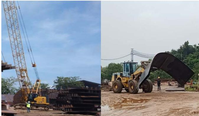
Gambar 3.4.15. Crawler Crane dan loader
