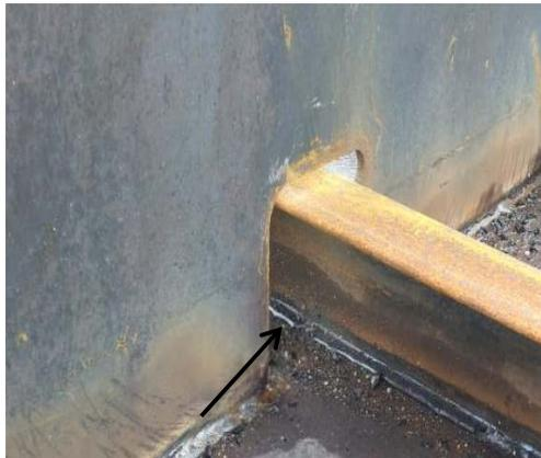
Gambar 3.2.6. Noces pada panel bottom tongkang
