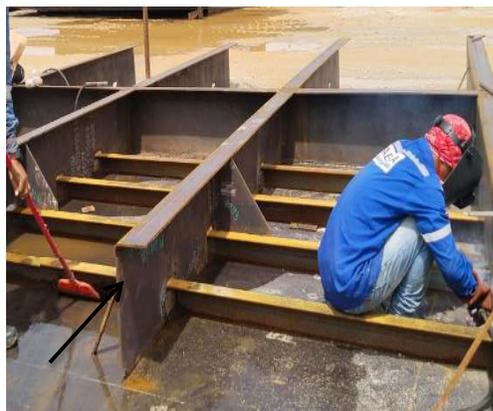
Gambar 3.2.4. Web frame pada panel bottom tongkang
