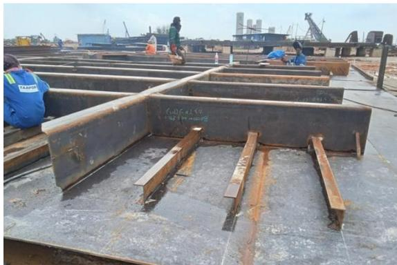
Gambar 2.12 Fit Up Bottom tongkang H-183
