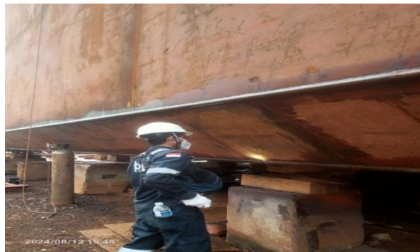
Gambar 2. 78. Air Test Eksternal bersama BKI Surveyor
