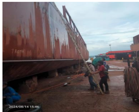
Gambar 2. 84. Air Test Eksternal bersama BKI Surveyor
