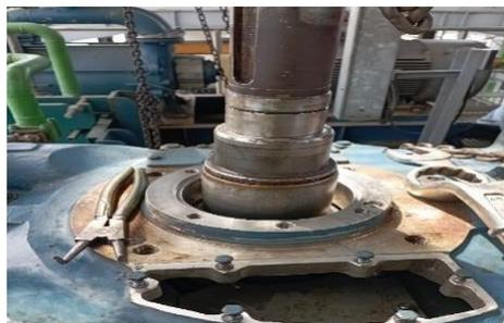
gambar 1 10 penggantian *shaft sleeve* pada *pompa vakum*
