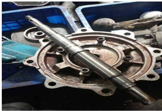
gambar 1 16 Penggantian bearing pada shaft pompa
