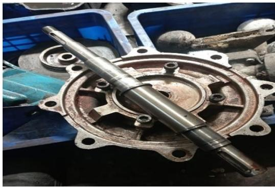
gambar 1 16 Penggantian bearing pada shaft pompa
