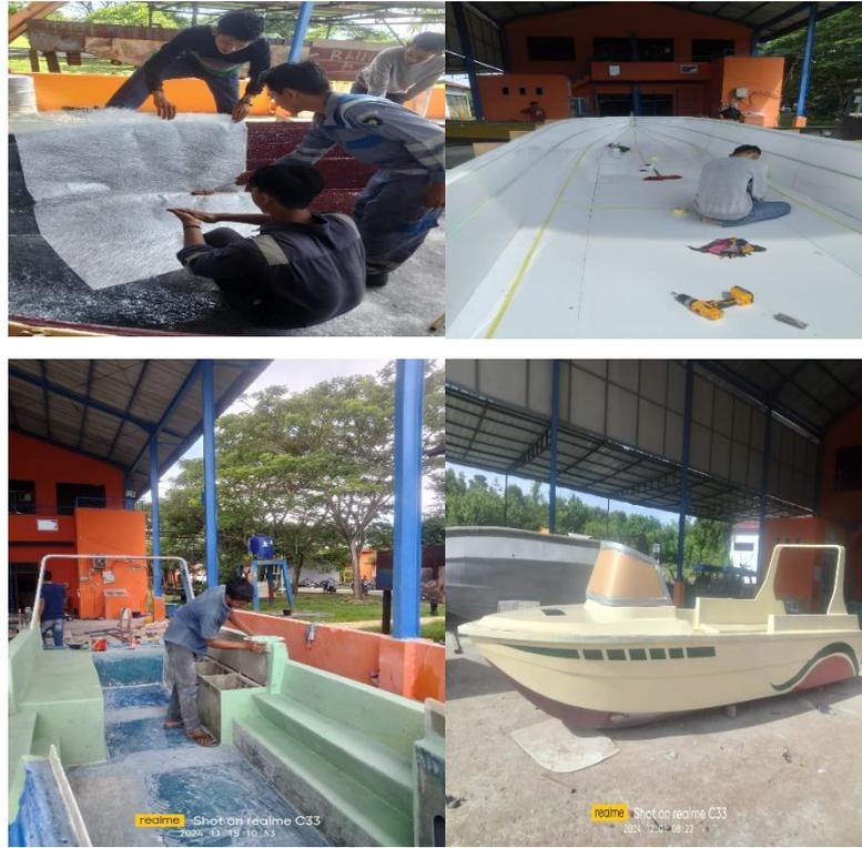
**Gambar 3. 4** Proses dempul, geol coat, dan laminasi
