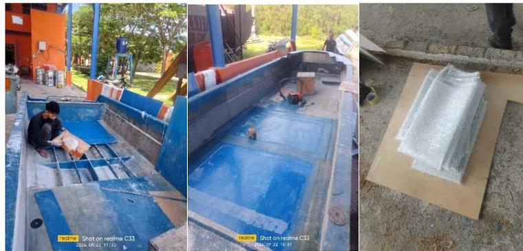
**Gambar 2.6** Laminasi ke 15, Pemasangan gading ke 12, dan void
