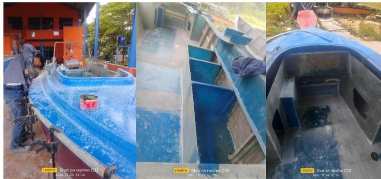
**Gambar 2.9** Laminasi ke 22, pemasangan gading 22, dan fender ke 22
