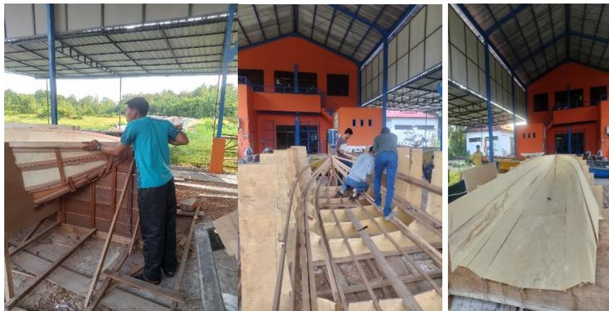
**Gambar 2.1** Pembuatan cetakan kapal ambulan
