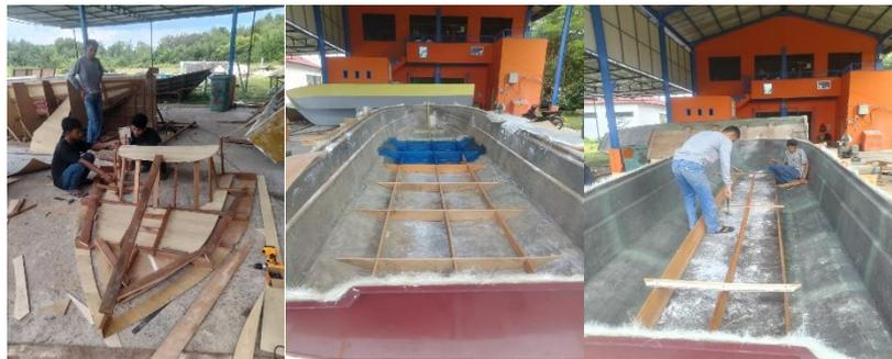
**Gambar 2.5** Laminasi ke 13, pemasangan gading 9 dan void
