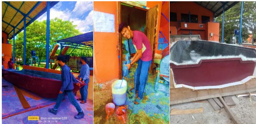
**Gambar 2.4** Laminasi ke 9, pemasangan gading ke 3, dan fender
