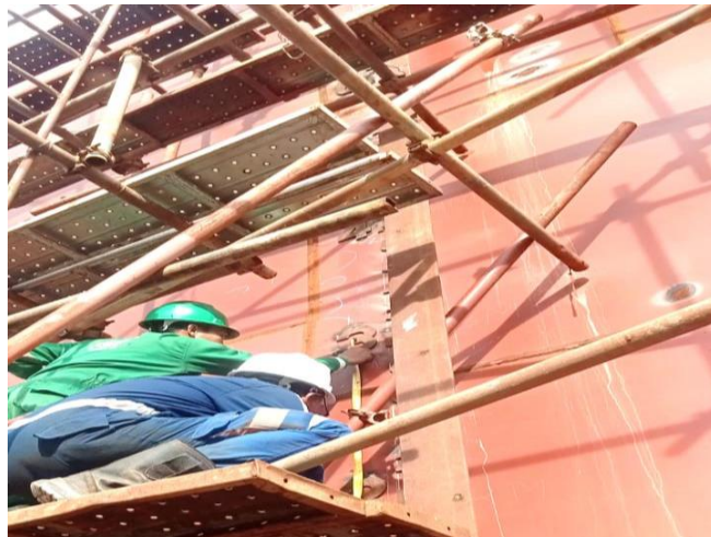
Gambar 2.82 Pengukuran draft mark
