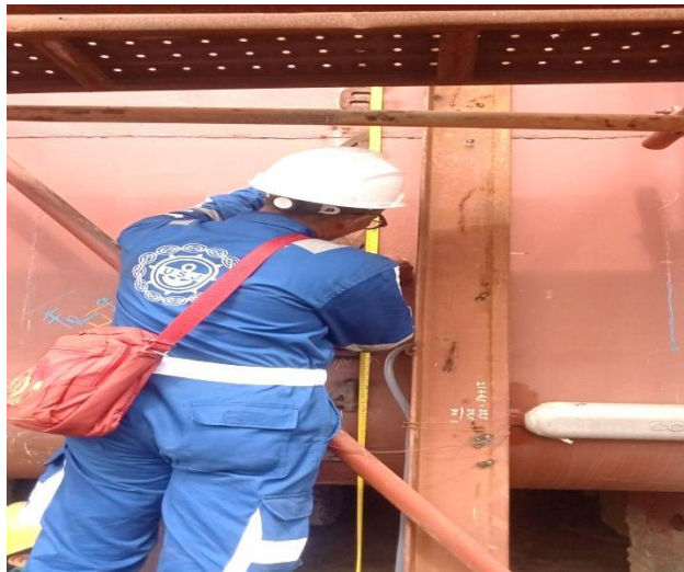
Gambar 2.76 Pengukuran draft mark
