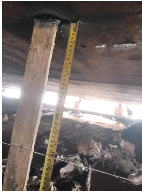
Gambar 2. 59 proses keel deflection
