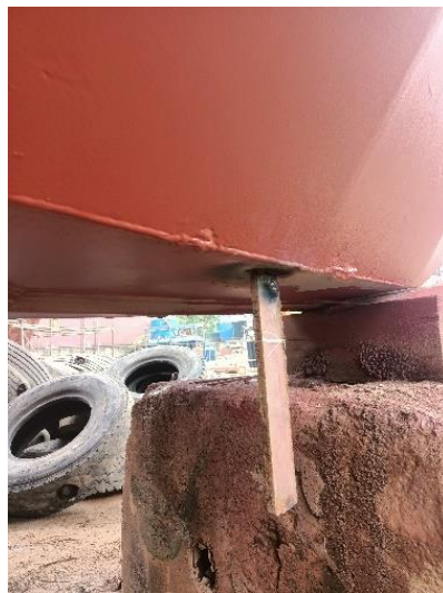
Gambar 2. 85 proses keel deflection
