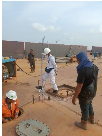
Gambar 2. 24 Air Pressure Test oleh class
