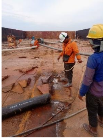
Gambar 2. 56 External dan intrnal airtest
