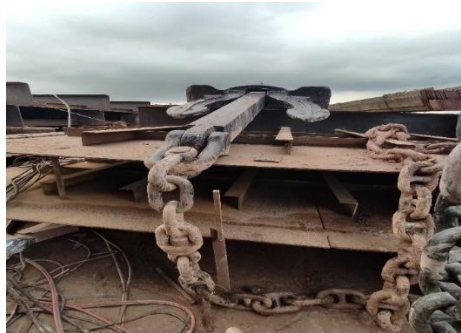
Gambar 2. 80 Pemasangan segel jangkar
