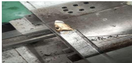
Gambar 4. 7 Pemasangan mata pahat Sumber: Dokumentasi.
