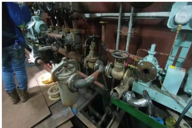
*Gambar 2. 62 Komponen-komponen perpipaan kapal*
