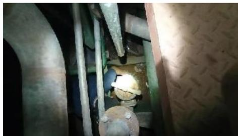
Gambar 2. 66 Pemasangan plastik berisi air pada bilga di *bilge well*
