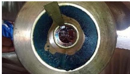
Gambar 2. 93 Kondisi dalam propeller hub setelah contact fit
