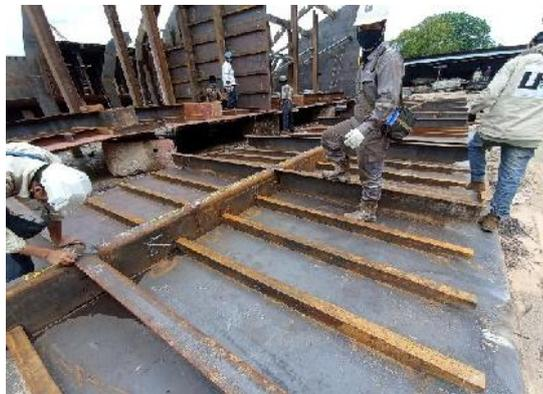
*Gambar 2. 18 Welding Inspection pada panel trans bulkhead*
