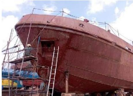
Gambar 2. 21 Proses eksternal *Air Test*
