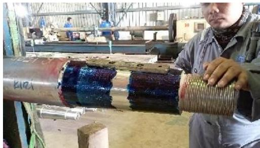
Gambar 2. 92 Proses pengolesan taper dengan prussian blue
