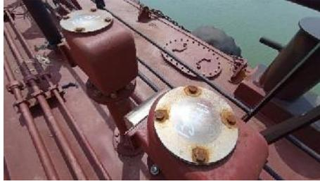
Gambar 2. 91 Marking warna pada air vent
