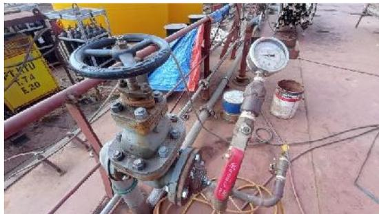
Gambar 2. 53 *Hydro test pada pipa hydrant main deck*
