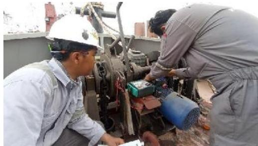
Gambar 2. 70 Proses megger test pada windlass
