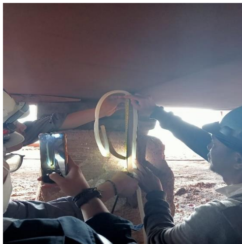
Gambar 2. 4 Proses Keel Deflection
