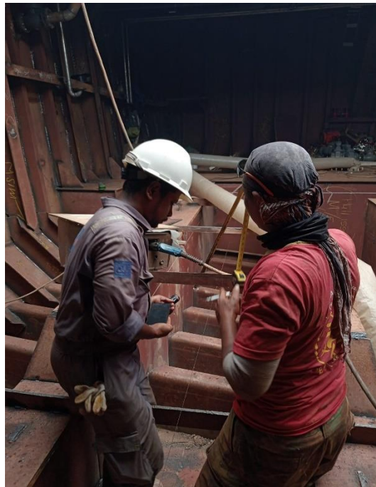
Gambar 3.8 Mengukur jarak Engine Girder dan Tank Top
