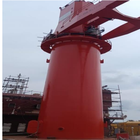
Gambar 2. 23 pedestal pada crane barge
