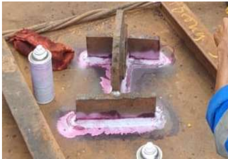
Gambar 3. 12 Proses setelah dilakukan penyemprotan developer
