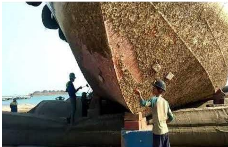
Gambar 3.1 Penyekrapan Lambung Kapal
