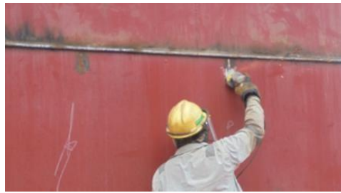
Gambar 2.31 Penggrindaan sambungan lasan kapal CB.Ab2
