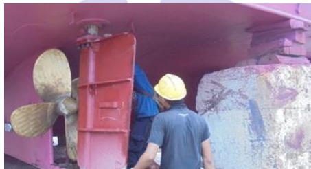
Gambar 2.36 Pemasangan Propeller TB.Sotalia Dolphin
