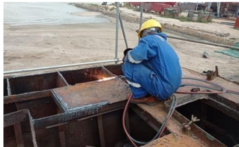
Gambar 2.4 Pemotongan plat top stering room
