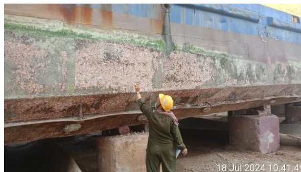
Gambar 2.10 Menghitung jumlah zinc anode
