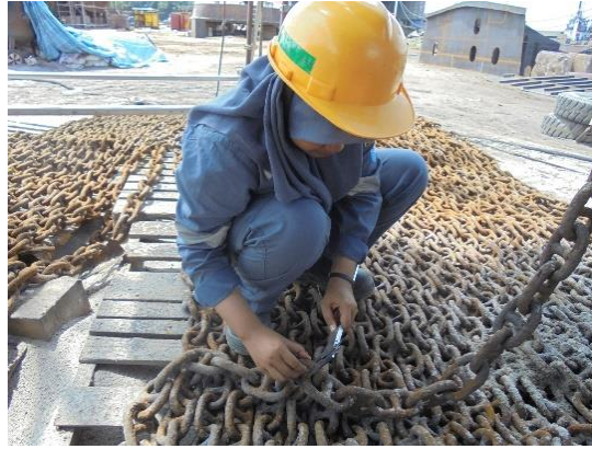
Gambar 2.24 kalibrasi pada rantai jangkar
