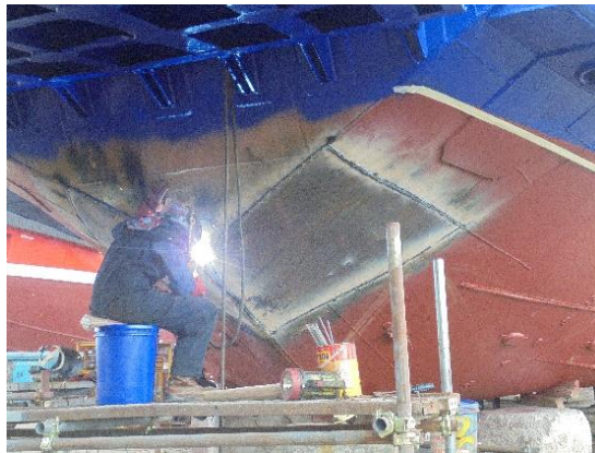
Gambar 2.19 repair plate bagian bottom
