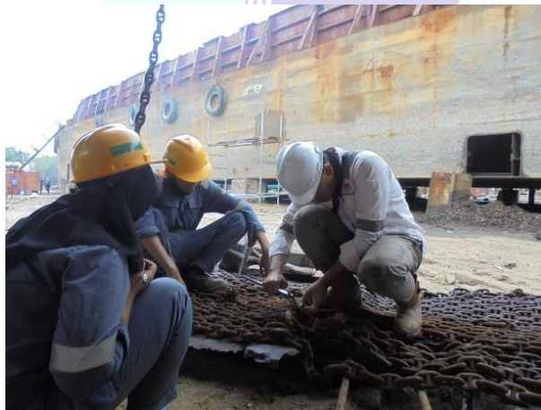
Gambar 2.33 kalibrasi pada rantai jangkar
