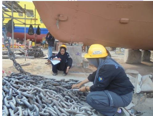
Gambar 2.42 kalibrasi pada rantai jangkar
