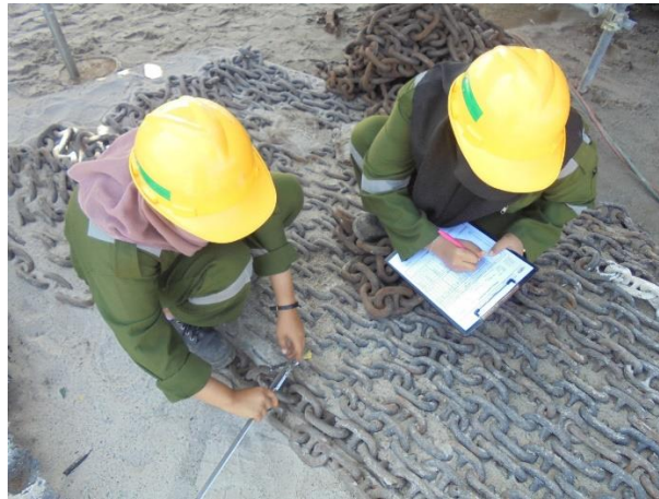
Gambar 2.30 kalibrasi pada rantai jangkar
