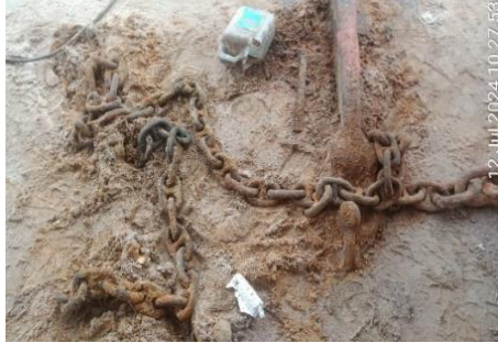
Gambar 2.3 Kalibrasi pada rantai jangkar KT. Hang Tuah VII
