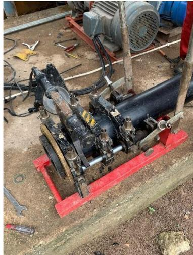
Gambar 3 9 mesin las pipa HDPE
