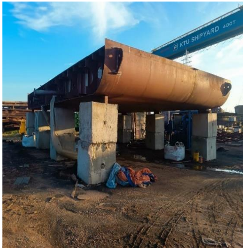
Gambar 2.28 melakukan survey progres pembuatan bottom and port-starboard kapal gearless
