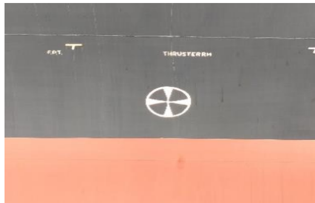
Gambar 2.51 thruster atau juga bow thruster
