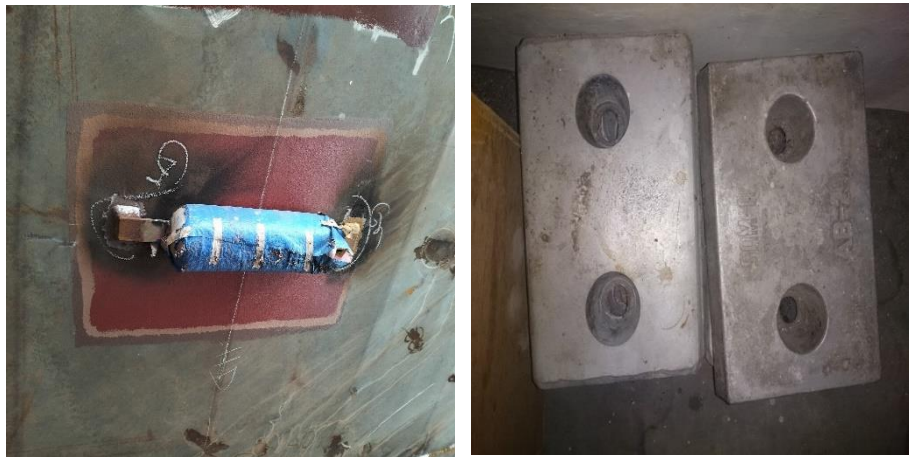
Gambar 2.48 Zinc anode yang terpasang pada kapal Gearless
