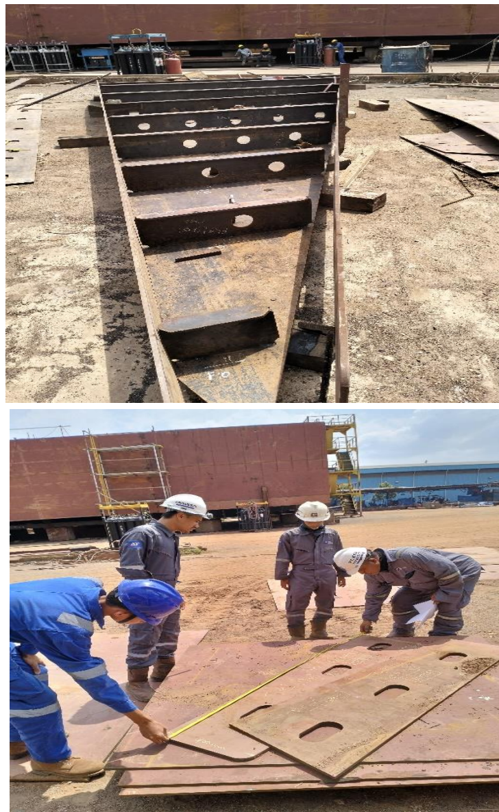
Gambar 2.19 Melakukan survey proses pembuatan Skeg pada kapal tongkang
