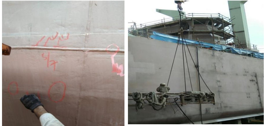
Gambar 2.55 mengamati proses sandblasting pada lambung kapal gearless
