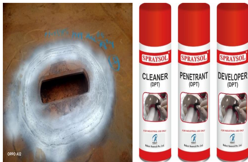
Gambar 2.33 Melakukan atau mengikuti proses Inspeksi Non Destructive Tes (NDT)
