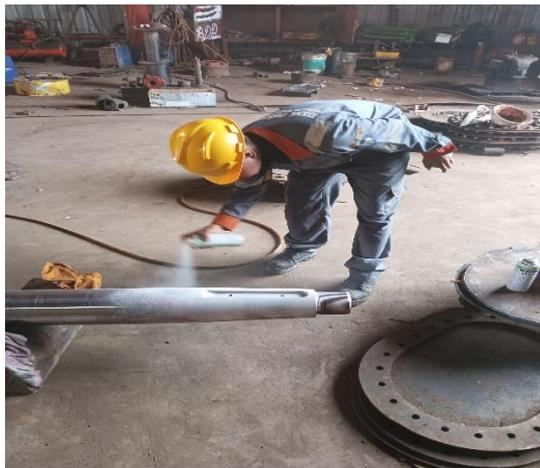
**Gambar 2.20** Penetrant Test bagian Crankshaft
