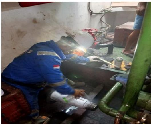
**Gambar 2.3** *Penetrant Test bagian shaft*
