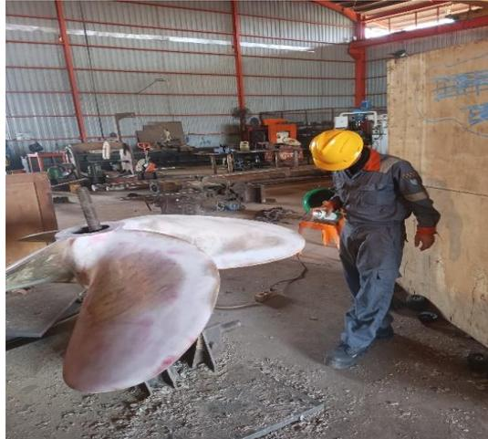
**Gambar 2.19** penetrant test pada bagian propeller
