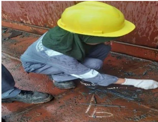
Gambar 2 27 Melakukan Air Test eksternal
