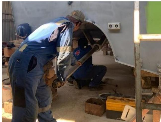
Gambar 3 9 pemasangan shaft
