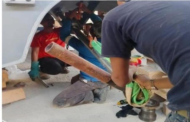
Gambar 3 8 percobaan pemasangan shaft
