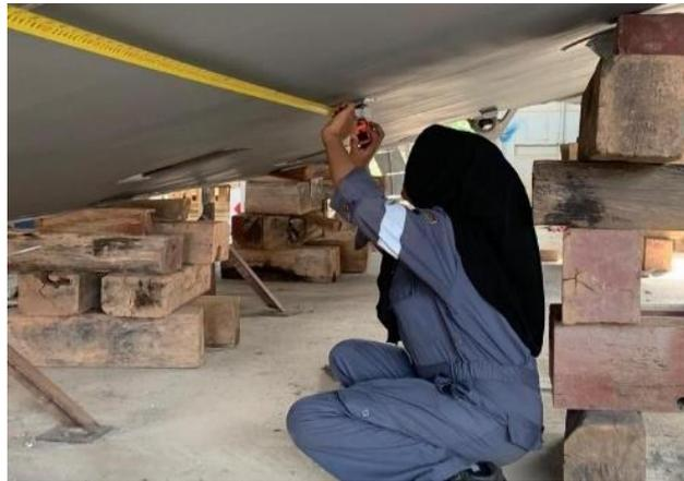
Gambar 2 13 Pengecekan dibagian shaft bracket
