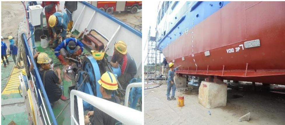
*Gambar 2.35 Inspek Perbaikan Pipa Hydrolic*
