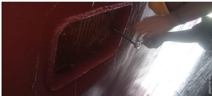
*Gambar 2.3 Pemasangan Kotak Saringan Sea Chest*
