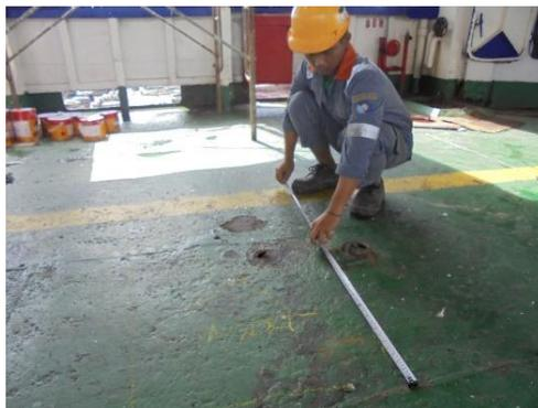
*Gambar 2.23 Pengukuran Plat Main Deck*
