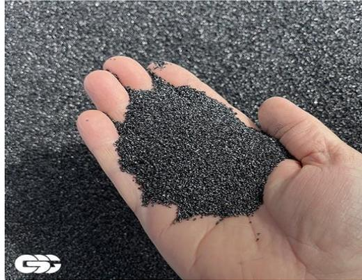
Gambar 3.19 Partikel abrasive copper slag
