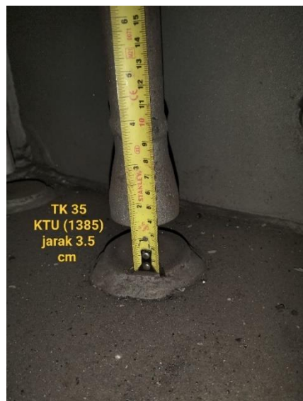
Gambar 2.20 Melakukan pengukuran dan pengecekan jarak pemasangan gap pipe pada tangki sounding kapal Gearless Mvp.
