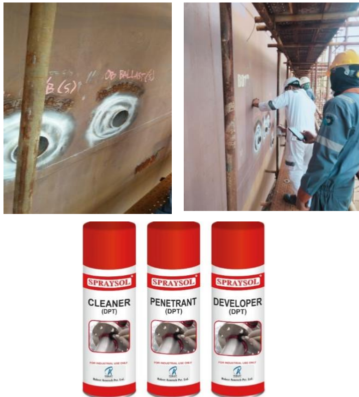
Gambar 2.35 Melakukan atau mengikuti proses Inspeksi Non Destructive Tes (NDT) pada bagian overboard .
