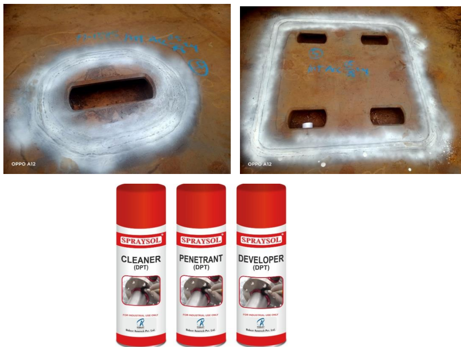
Gambar 2.33 Melakukan atau mengikuti proses Inspeksi Non Destructive Tes (NDT)
