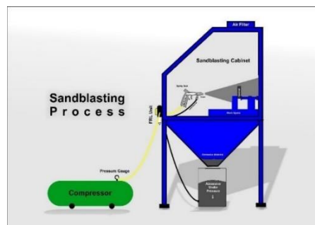
Gambar 3.12 Prinsip kerja sandblasting
