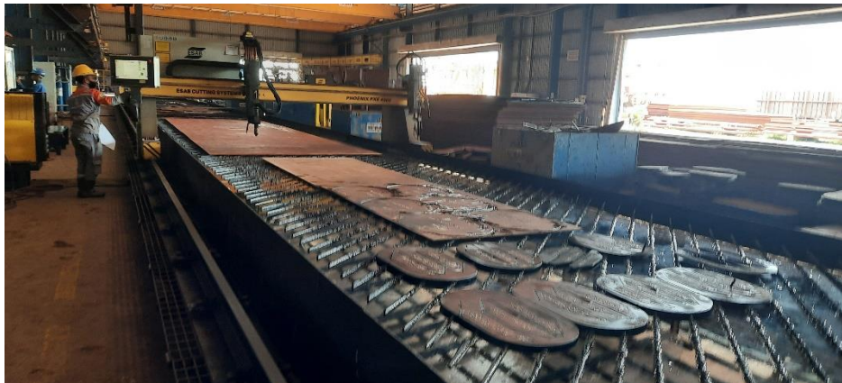
Gambar 2.55 Proses sesudah pemotongan.
