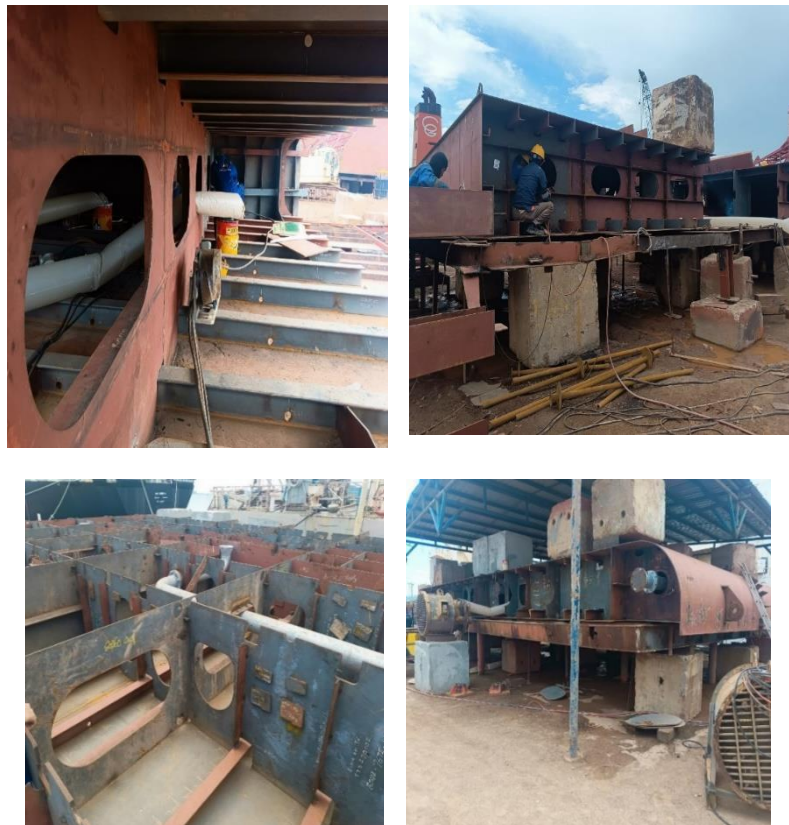
Gambar 2.29 Melanjutkan survey proses pembuatan Bottom, Prot Side and Starboard pada kapal Gerless.
