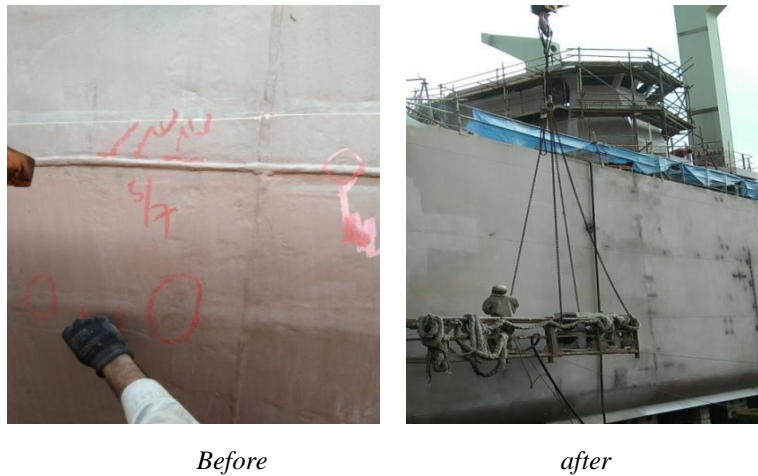
Gambar 2.56 Proses sandblasting pada lambung kapal Gearless.
