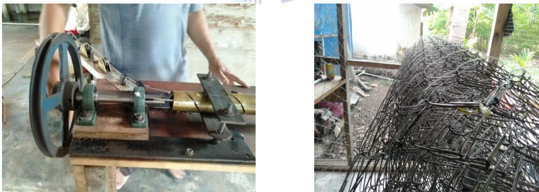
Gambar 1.1 Alat pembuat kawat harmonika Pak Saymin Desa Penebal (a) Alat pembuat kawat harmonika manual, (b) Hasil kawat harmonika
