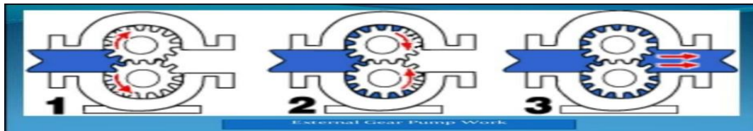
Gambar 4.2. Cara kerja pompa roda gigi pada forklift
