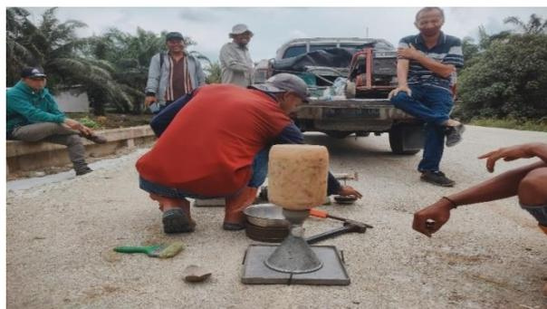
*Gambar 3.13. Pengujian Sand Cone Base B
