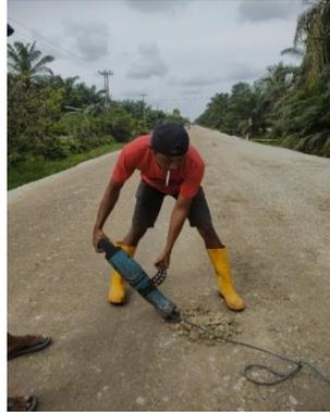
*Gambar 3.16. Pengujian Core Base A
