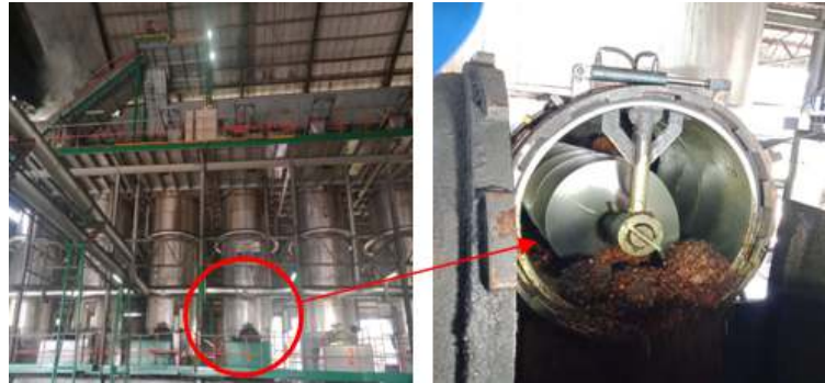
Gambar 1.6. Bejana uap bertekanan untuk merebus TBS Uap ( steam )
