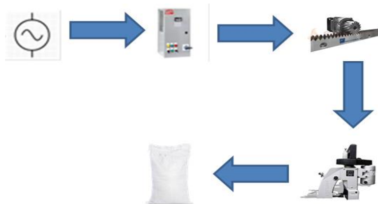
Gambar 3.1 Blog Diagram proses kerja mesin jahit (Sumber: Dokumentasi pribadi, 2021)
