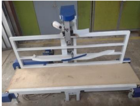
Gambar 3.2. Mesin Jahit Otomatis Sumber : Dokumentasi Pribadi di PT. Cassia Co-op
