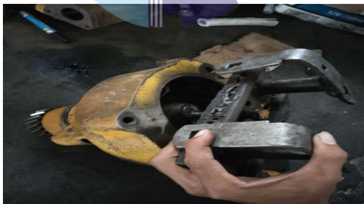
Gambar 4.5 Proses Pembongkaran Impeler Sumber: Dokumentasi
