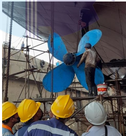
Gambar 2.3 Pemasangan Propeller KMP Kumala
