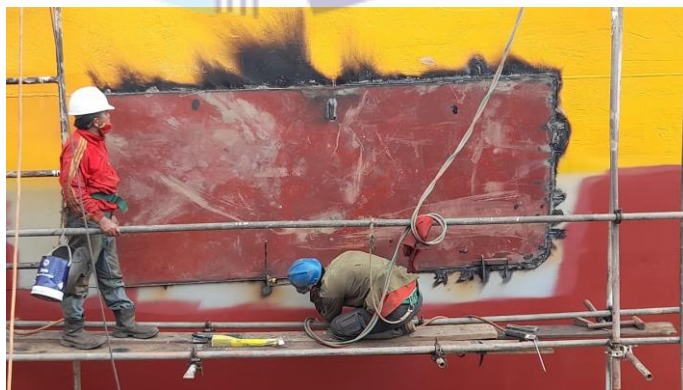
Gambar 2.34 Replating Lajur Side Shell Frame No. 64-68 Kapal MT. Sinar Masela
