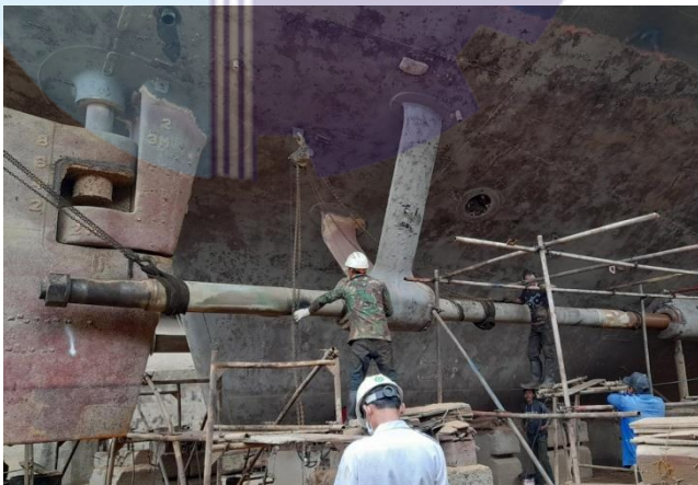
Gambar 2.18 Pelepasan Shaft Bagian Kanan Kapal Kirana III
