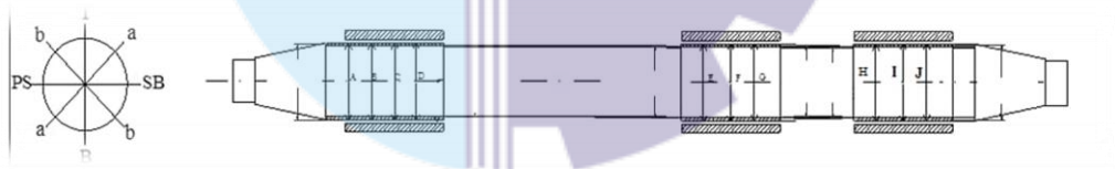
Gambar 3.2 Posisi yang di Spray Metal (posisi V Vraket: a,b,c,d)
