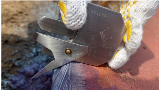
Gambar 2.35 Proses Pengukuran Sudut Kemiringan Bevel
