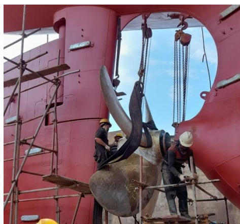
Gambar 2.36 Proses Pemasangan Propeller Kapal MT. Sinar Masela
