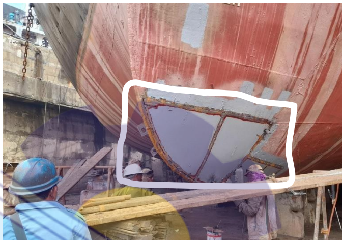
Gambar 2.4 Replating Posisi Linggi Haluan Kapal Tongkang Parameswara
