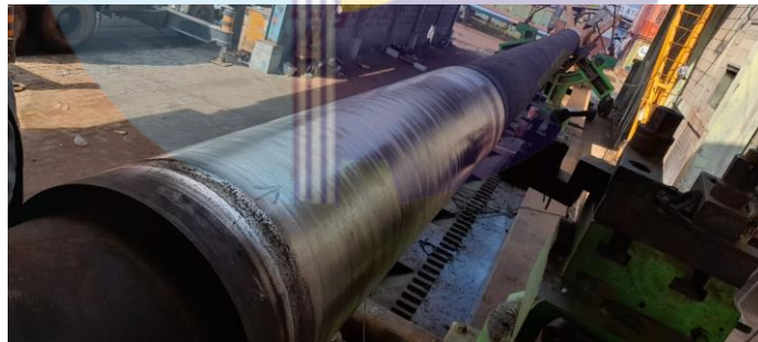
Gambar 3.12 Bentuk Permukaan Sleeve Pasca Penghalusan
