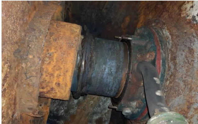
Gambar 2.17 Pembongkaran Flends Kopling Sebelah Kanan KM Kirana III
