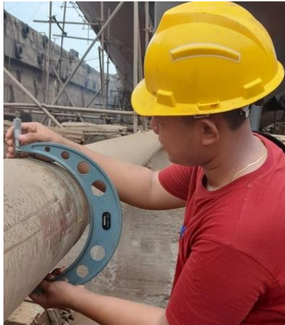
Gambar 3.4 Pengukuran OD Shaft
