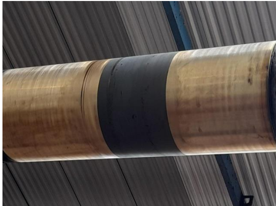
Gambar 2.27 Area Shaft MT. Triaksa yang ditambah Ketebalan
