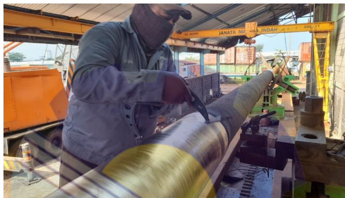
Gambar 3.13 Pengukuran OD Sleeve Baru Pasca Spray Metal
