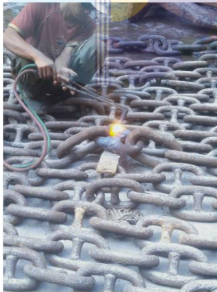
Gambar 2.21 Proses Penggantian Segel Rantai Jangkar Kapal Niki Sae
