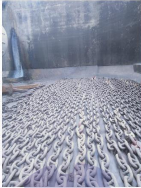
Gambar 2.20 Proses Perawatan Rantai Jangkar Kapal Niki Sae
