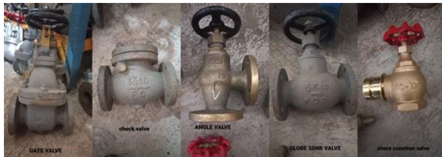
Gambar 2.13 Valve Yang Ada di Gudang Material Pt. YWTS
