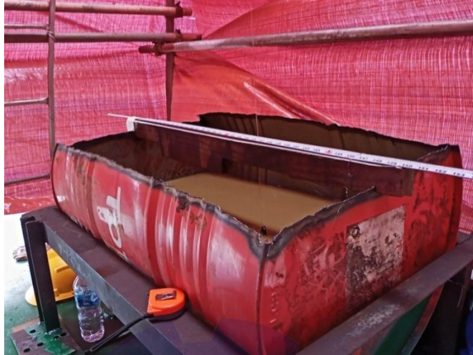
Gambar 2. 29 Alat bandul yang digunakan dalam proses inclining test
