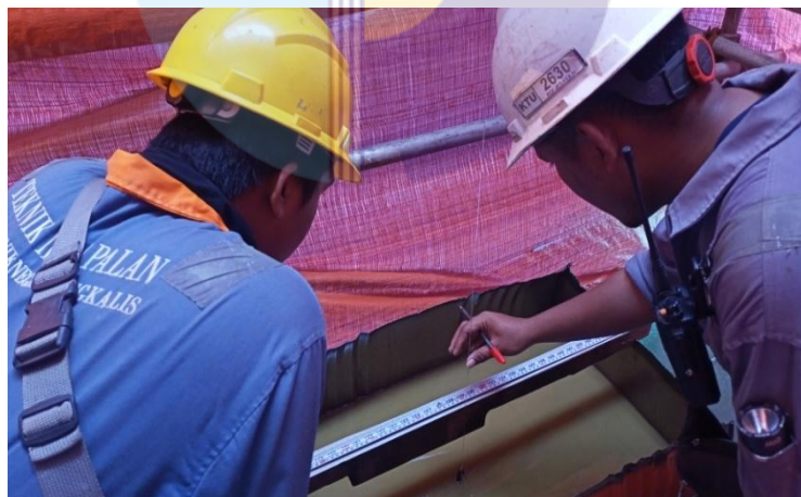
Gambar 2. 28 Proses inclining test pada kapal crane barge
