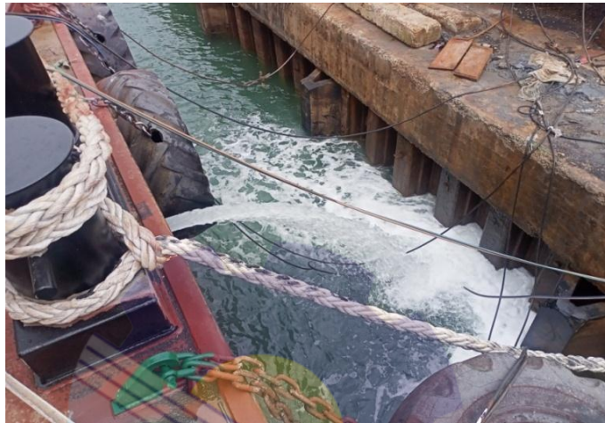
Gambar 2. 53 Pembuangan ballast melalui overboard
