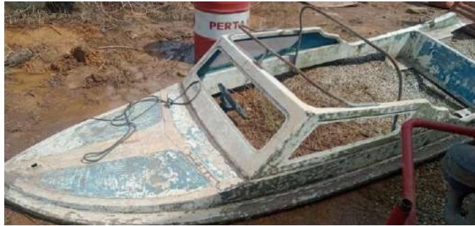
Gambar 2.1 Pembongkaran bagian atas speed boat Sumber : Dokumentasi pribadi 2021
