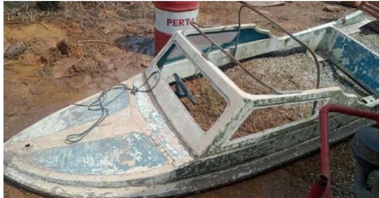
Gambar 3.18 Pembongkaran bagian atas speed boat Sumber: Dokumentasi pribadi 2021
