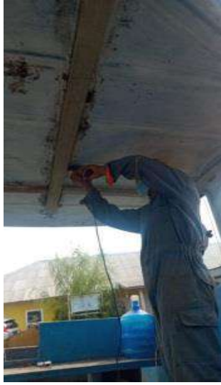
Gambar 2.21 Laminasi konstruksi atas speed boat Sumber: Dokumentasi pribadi 2021
