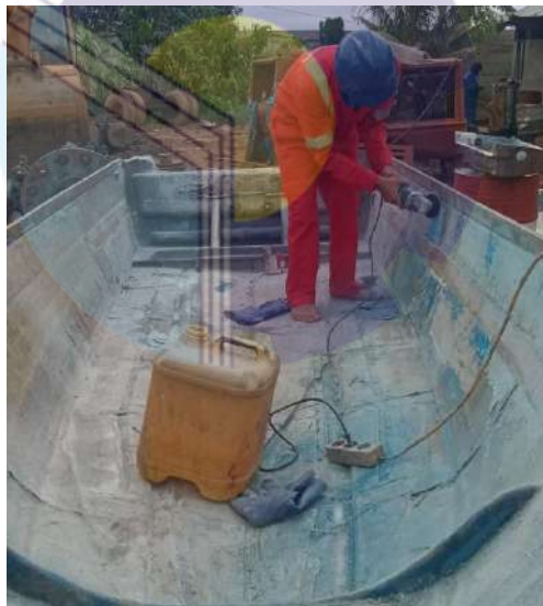
Gambar 3.22 Pengamplasan bodi bagian dalam Sumber: Dokumentasi pribadi 2021
