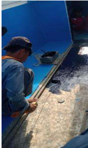
Gambar 2.39 Pengecatan pada bagian lantai speed boat Sumber: Dokumentasi pribadi 2021
