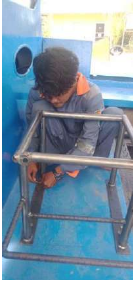
Gambar 2.50 Pemasangan bingkai kursi speed boat Sumber: Dokumentasi pribadi 2021
