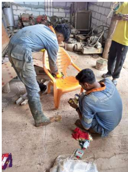
Gambar 2.28 Mengoleskan mirror pada kursi Sumber: Dokumentasi pribadi 2021
