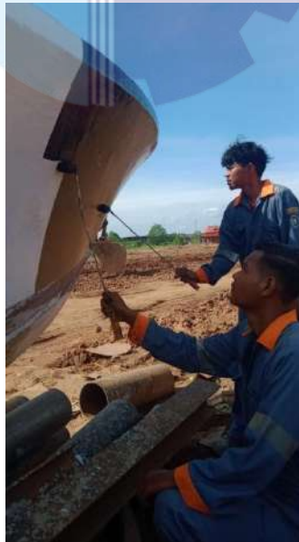
Gambar 2.48 Pengecatan lapisan Sumber: Dokumentasi pribadi 2021
