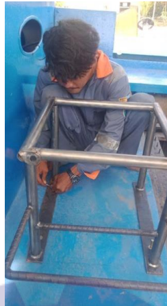
Gambar 2.49 Pemasangan Kursi Speed Boat
