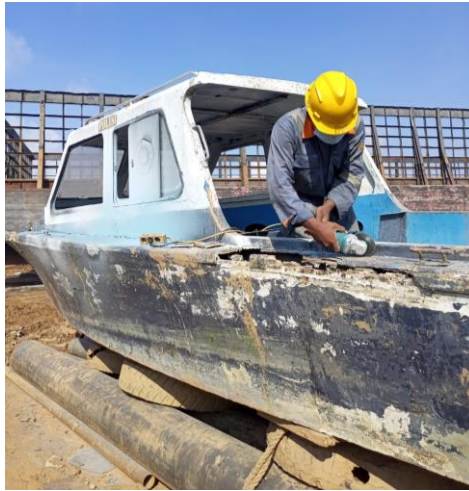
Gambar 3.3 Memotong Bagian Speed Boat Yang Rusak
