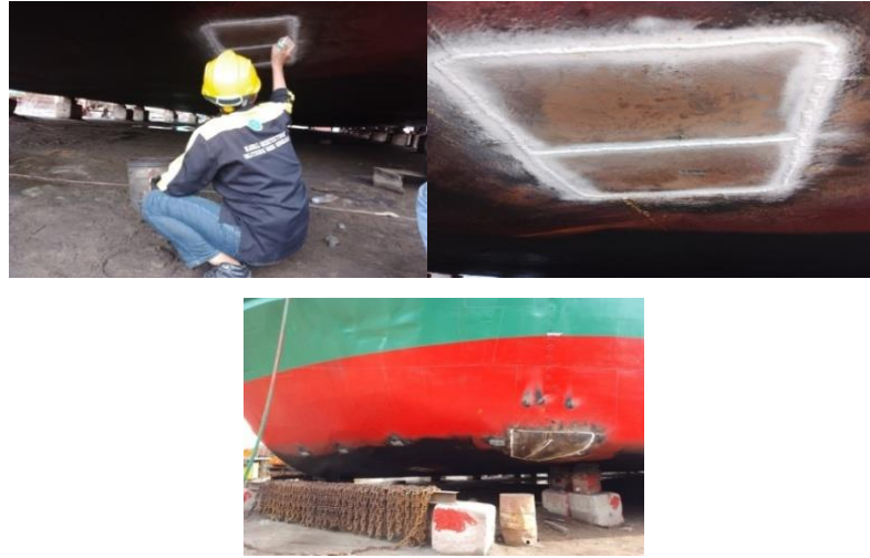
Gambar 2.27 Penetrant test di kapal SPOB Wijaya Kusuma 3
