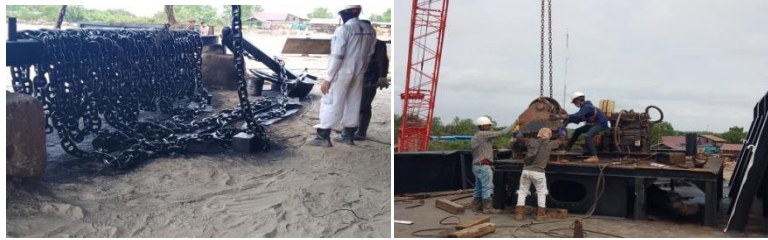
Gambar 2.50 Peninjauan painting rantai jangkar repair rumah jangkar tongkang indosukses
