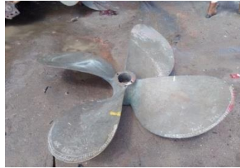
Gambar 3.11 Pengikisan daun propeller
