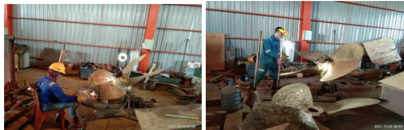
Gambar 3.4 Proses Fairing Propeller dan pemukulan
