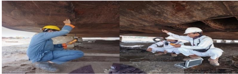
Gambar 2.40 Uji NDT bottom kapal Tongkang BGFPS 06A
