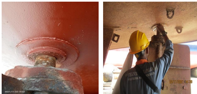
Gambar 2.17 gambar poros as daun kemudi yang di clearance .
