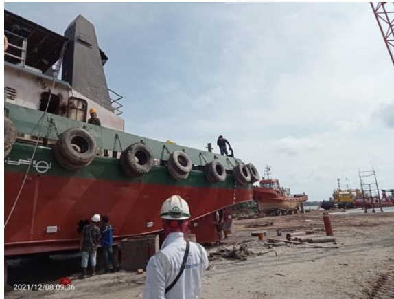
Gambar 2.25 proses pemasangan dafra TB NELLY 19
