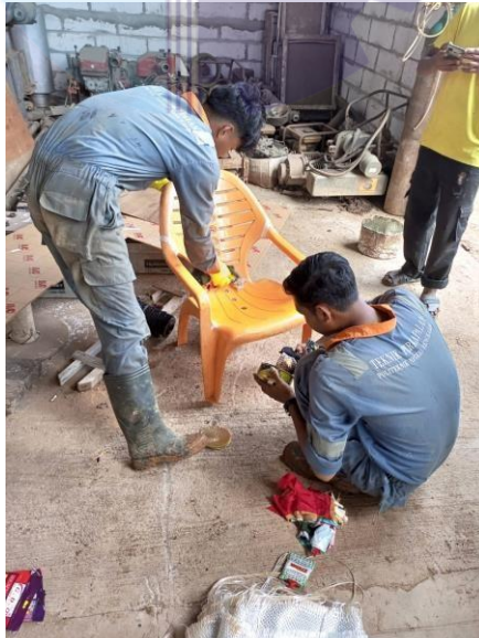
Gambar 2.28 Mengoleskan mirror pada kursi
