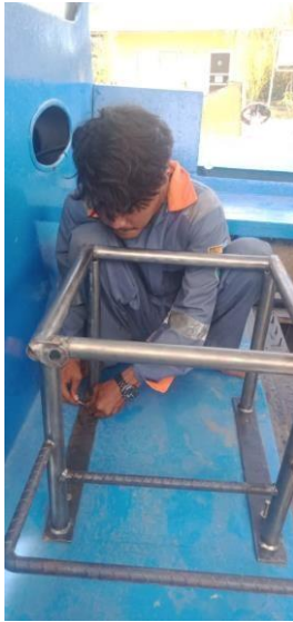
Gambar 2.50 Pemasangan bingkai kursi speed boat
