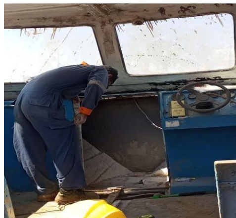
Gambar 2.58 Pemasangan lantai pada speed boat
