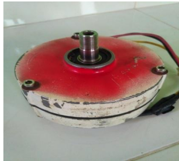
Gambar 2.7 Generator AC 3 Phase (Sumber: Dokumentasi, 2019)
