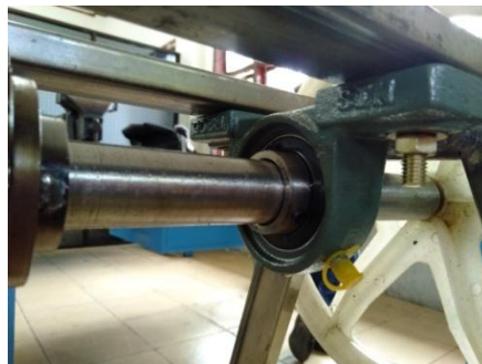
Gambar 2.10 Bearing duduk (Sumber: Dokumentasi, 2019)
