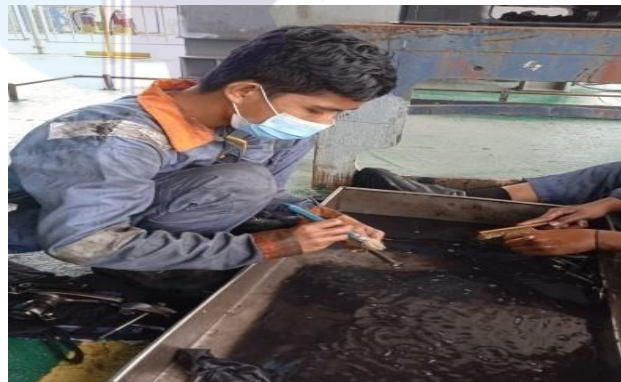
Gambar 2.3 Proses Pembersihan Komponen Mesin
