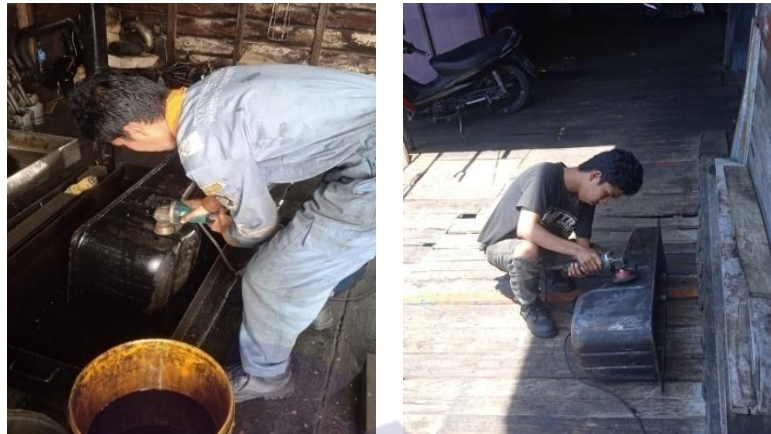
Gambar 2.6 Proses Pembersihan Menggunakan Gerinda
