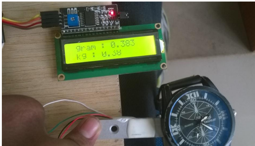
Gambar 4.2 Pengujian Load Cell (Sumber: Dokumentasi Priadi, 2018)
