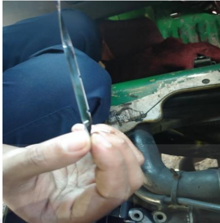
Gambar 4.18 Pengecekan Kadar Oli Yang Tersisa
